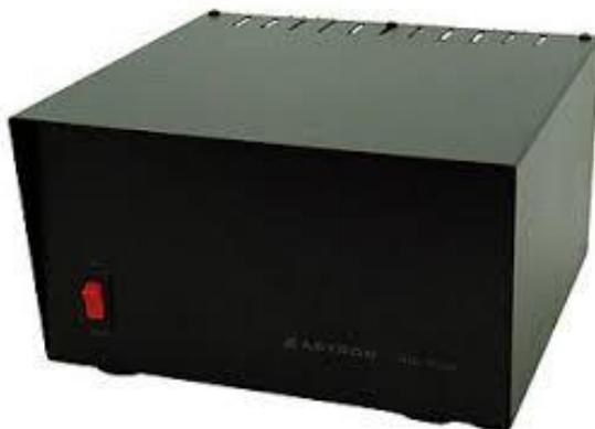
Finalmente, hay dos tipos diferentes de fuente de alimentación. El primero es un diseño lineal. Este tipo de fuente utiliza un transformador incorporado para convertir la energía de 220 voltios C.A. en 13,8 voltios C.C. Estas fuentes tienden a ser pesadas y voluminosas, porque el transformador es pesado.
