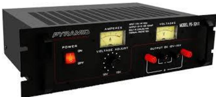
Para empezar, todos los sistemas de radio HAM funcionan con 13,8 voltios. Sin embargo, el amperaje varía ampliamente entre diferentes sistemas. Cuanto mayor sea el amperaje, más potente será su señal. Si está usando un receptor de mano pequeño, puede usar la batería incorporada. Y si no desea usar la batería, puede comprar una fuente de alimentación pequeña y
